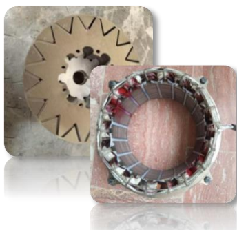
ژنراتور ۳ کیلو وات روتور درونی ۶۰۰ دور بر دقیقه بادی ۷ شکل
