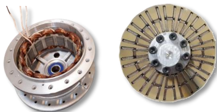
موتور H شکل ۶۵۰ وات با کاربرد موتور سیکلت برقی
